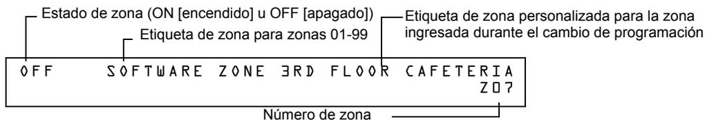
**Figura 4.4** Ejemplo de visualización de la lectura de estado de una zona de software
