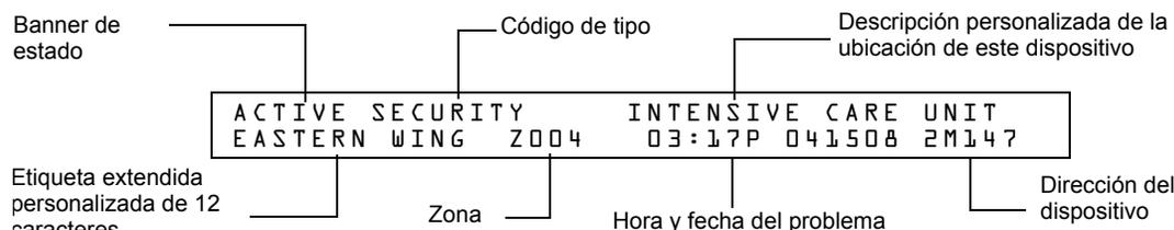
**Figura 3.7 Ejemplo de mensaje de alarma de seguridad**
